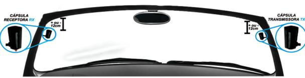
**IMPORTANTE!!!** Faça testes periódicos no ultrassom para confirmar o seu funcionamento, ressaltando que este é o sensor mais importante na proteção do veículo.
