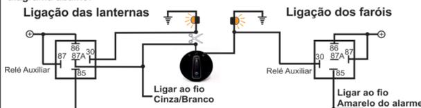
**11.4. Função de temporizar faróis:** Esta função possibilita temporizar os faróis por 30 segundos ao ligar/desligar o alarme pelo controle remoto com a ignição desligada. Após programar a função, a temporização dos faróis funcionará da seguinte maneira: Apertar [ ] por 500ms e solte depois apertar novamente por 2 segundos.
