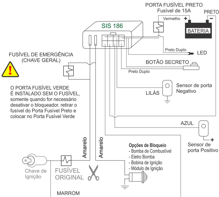
O PORTA FUSÍVEL VERDE É INSTALADO SEM O FUSÍVEL, somente quando for necessário desativar o bloqueador. retirar o fusível do Porta Fusível Preto e colocar no Porta Fusível Verde
