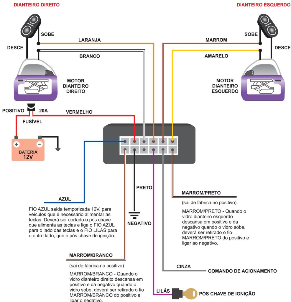
FIO AZUL saída temporizada 12V, para veículos que é necessário alimentar as teclas. Deverá ser cortado o pós chave que alimenta as teclas e liga o FIO AZUL para o lado das teclas e o FIO LILÁS para o outro lado, que é pós chave de ignição.
